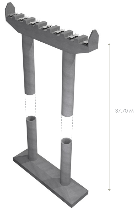
FRONTAL PIER VIEW ELEVACIÓN FRONTAL CEPA
